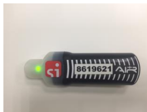
Рис.2 Периодически мигающий зеленый световой индикатор, говорит о том, что ЧИП находится в активированном состоянии и готов к работе.
