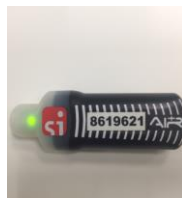
Рис.3 Периодически мигающий зеленый световой индикатор; говорит о том, что чип SIAC находится в активированном состоянии и готов к работе.
