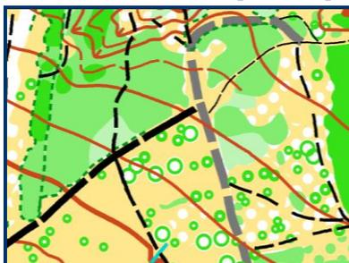
Ввиду особенностей местности, овраги прорисованы с сечением рельефа 5 метров (линия горизонтали прерывается, переходит в полугоризонталь – фрагмент 1). Противопожарные пропашки шириной 8 метров (перепаханный грунт без дороги) обозначены штриховой линией серого цвета (фрагмент 2).
